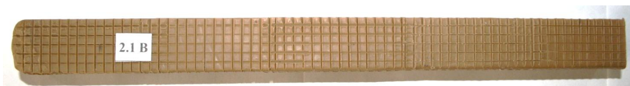
Рис. 2. Вид пластилинового образца после разливки и нанесения координатной сетки
